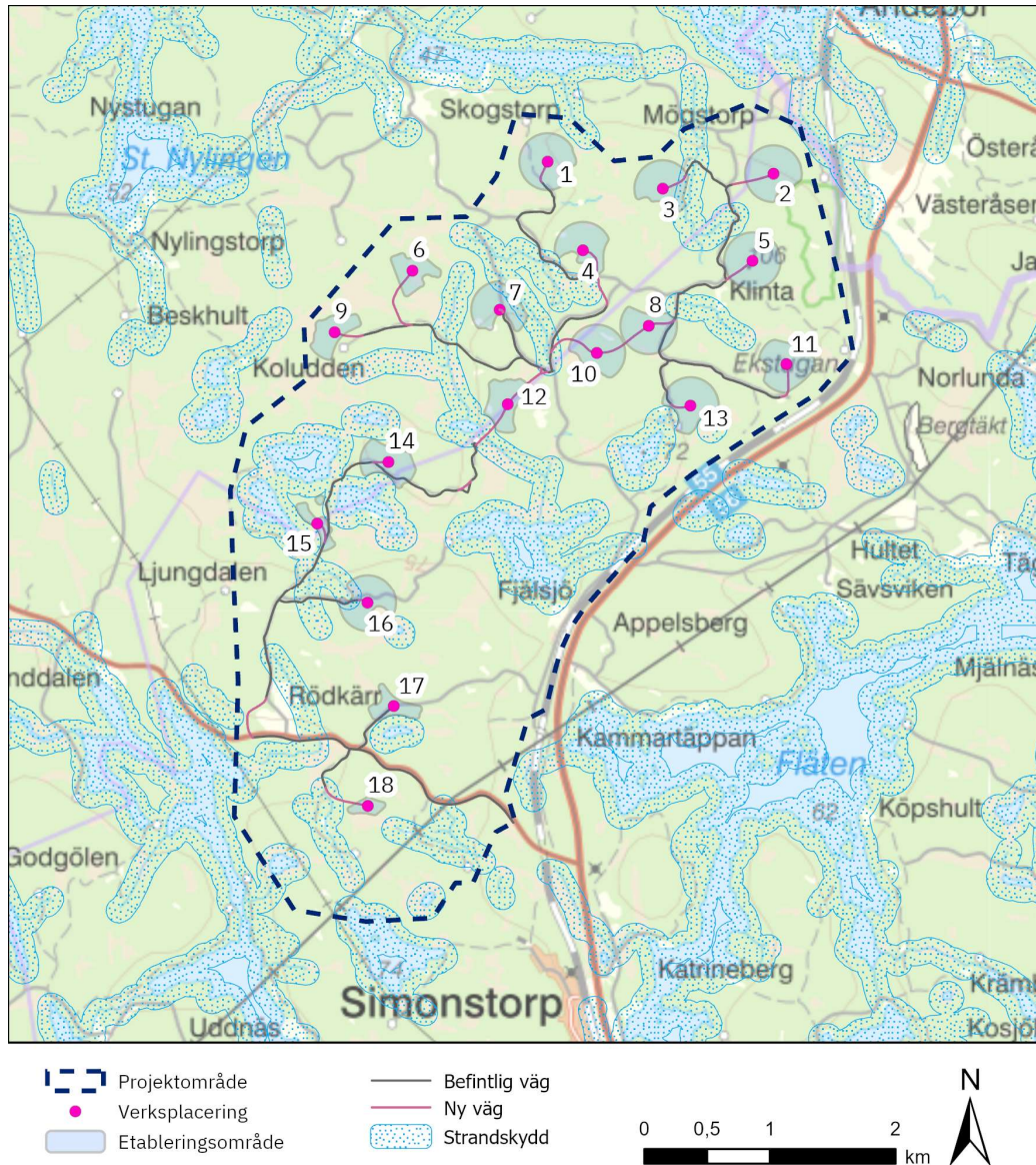
FIGUR 7-8: STRANDSKYDDADE OMRÅDEN INOM VINDKRAFTSPARK KLINTABERGET, ETABLERINGSOMRÅDEN OCH VÄGAR. ÄVEN VATTENOMRÅDEN OMFATTAS AV STRANDSKYDD, VILKET INTE REDOVISAS I KARTAN.
